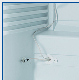
Passage cuve Ø 15 mm pour sonde GTC (Gestion Température Centralisée) - PT100 ou numérique.
